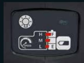
Selección del modo de martilleo según la dureza del material
