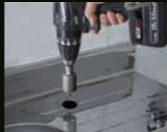
Perçage vertical dans le métal (Mode haut)
