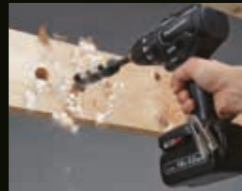
Perçage dans le bois (Mode haut)
