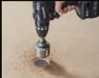
Perçage vertical dans les panneaux de bois
