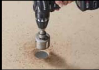
Bohren vertikal in Platten
