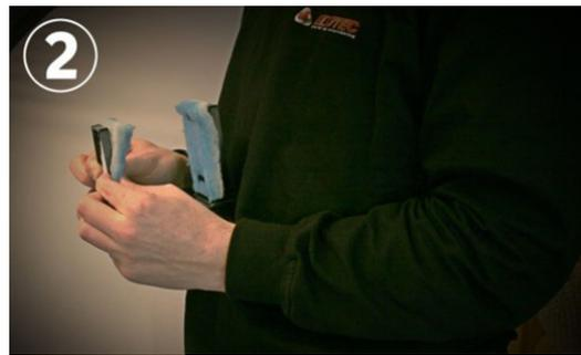
Finalmente, reinstale el cartucho, asegurándose de que está correctamente colocado. Utilice el pulgar para comprobar si la parte delantera del cartucho está a ras de las dos zonas elevadas de la carcasa del filtro.
