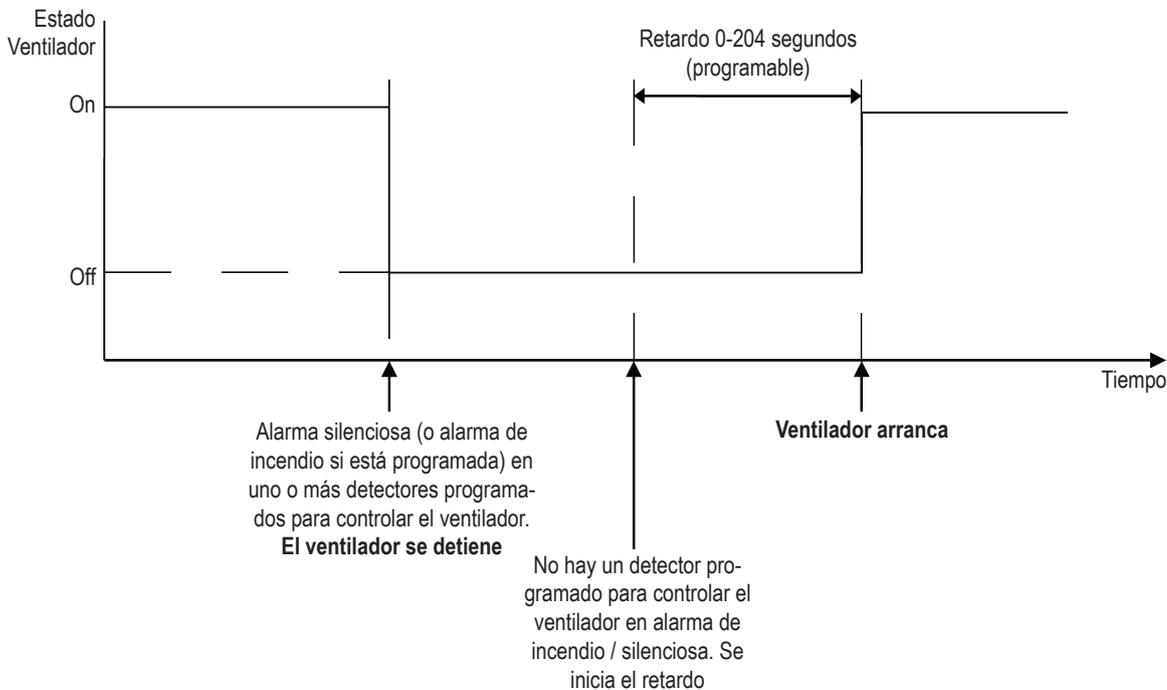
Se puede utilizar una salida de relé retardada para su desactivación, después de rearmar una alarma de incendio / alarma silenciosa, si algún detector, programado para controlar el ventilador, durante el tiempo de retardo se produce de nuevo una alarma de incendio / alarma silenciosa, el ventilador continuará apagado hasta que no haya ningún detector en alarma de incendio / alarma silenciosa y se iniciará un nuevo periodo de retardo.
