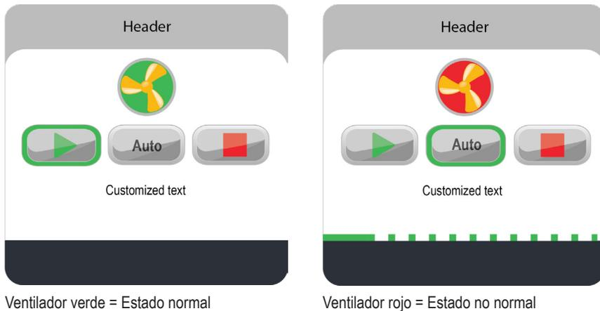
El módulo de control de ventilador/compuerta tiene una función normal para una "ventilación de suministro de aire" o una "ventilación estándar". También hay una función mejorada para una "Extracción de humo", "Dispersión de humo", "Presurización de escaleras" o un ventilador de "Ventilación forzada".
