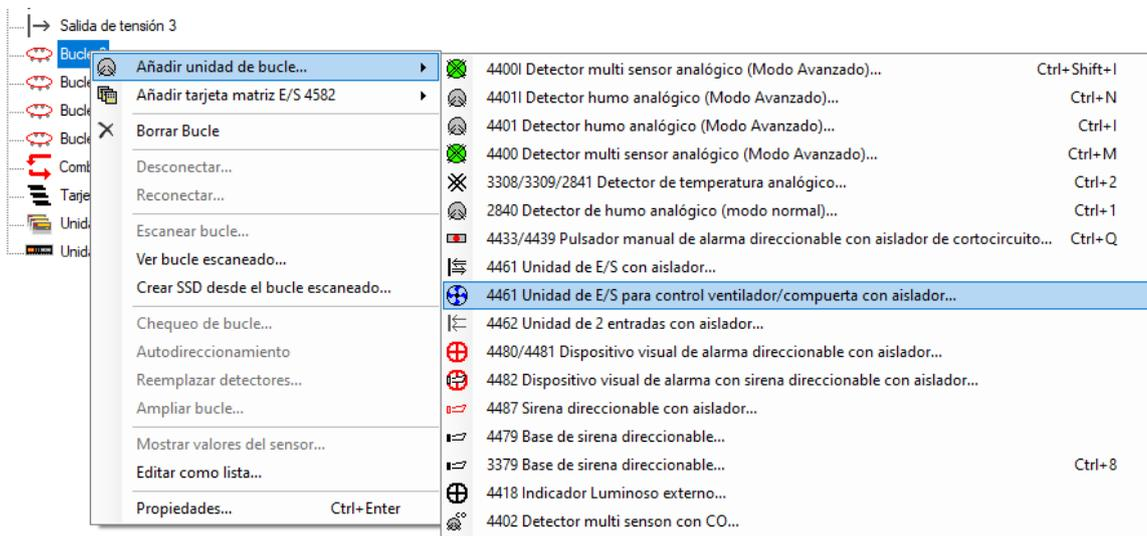
c) En el cuadro de diálogo de “4461 Unidad de E/S para control ventilador/compuerta”, conecte al 4461 la entrada de control de ventilador/compuerta.
