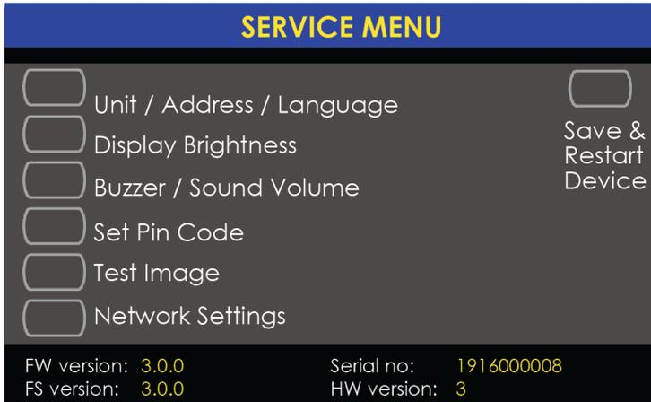
Para una unidad de visualización en funcionamiento, el menú Servicio se puede abrir a través del puente «J4» en la unidad. Extraiga los dos tornillos (Torx T10) en la parte inferior de la pantalla para abrir la unidad.
