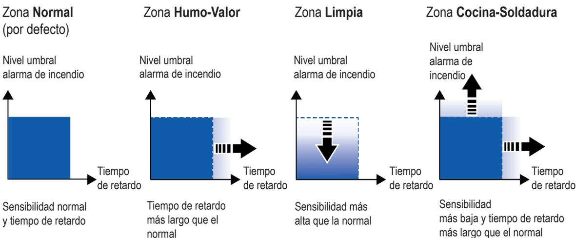
El algoritmo de alarma de la **Zona Calderas** es similar al algoritmo de alarma para la zona **Normal**, pero la función de tasa de incremento (deltaT) no se usará para la activación de la alarma.
