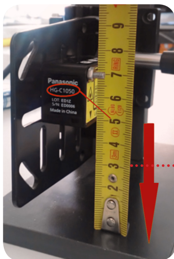
Exemple : HG-C1050-P Hauteur d'installation : 50mm
