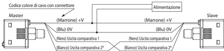
\*Per tipo multifunzione, uscita analogica in tensione/ingresso esterno.
