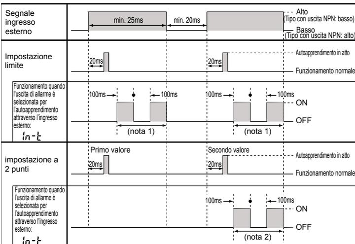
1. Se il margine è insufficiente, l'uscita commuta ON/OFF ogni 100ms mentre il segnale di ingresso esterno è ON dopo l'autoapprendimento.
