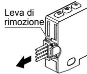
**Non estrarre il connettore senza premere la leva di rimozione! Il cavo o il connettore potrebbero rompersi.**
