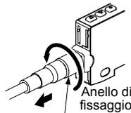
**Prima di rimuovere il cavo, l'anello di fissaggio deve essere completamente svitato! Applicando una forza eccessiva (superiore a 15N•m) si potrebbero causare danni.**
