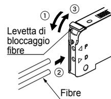
➡ Se il cavo è una fibra di tipo riflettente, p.es. FD-G4 o FD-FM2, inserire il cavo unipolare nell'ingresso di emissione raggio "P" e il cavo multipolare nell'ingresso di ricezione raggio "D." Se i cavi vengono inseriti al contrario, le prestazioni del sensore diminuiranno.
