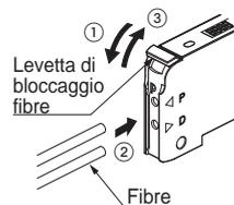
➡ Se il cavo è una fibra di tipo riflettente, p.es. FD-G4 o FD-FM2, inserire il cavo unipolare nell'ingresso di emissione raggio "P" e il cavo multipolare nell'ingresso di ricezione raggio "D." Se i cavi vengono inseriti al contrario, le prestazioni del sensore diminuiranno.
