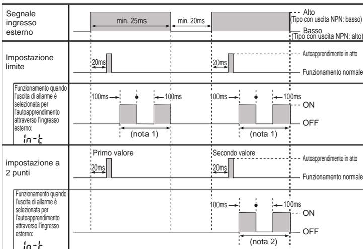
1. Se il margine è insufficiente, l'uscita commuta ON/OFF ogni 100ms mentre il segnale di ingresso esterno è ON dopo l'autoapprendimento.
