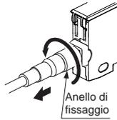
Prima di scollegare il cavo, allentare completamente l'anello di fissaggio. Se il cavo viene estratto con eccessiva forza (oltre 15N) quando l'anello di fissaggio è serrato, il cavo può rompersi.
