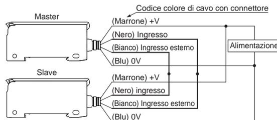
3. Mettere contemporaneamente su ON l'amplificatore master e l'amplificatore slave (vedere la nota)!
