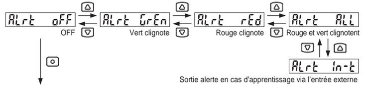
La sortie alerte en cas d'apprentissage via l'entrée externe fonctionne uniquement lorsque le mode d'apprentissage de la valeur limite ou le mode d'apprentissage en 2 étapes est paramétré pour l'entrée interne.
