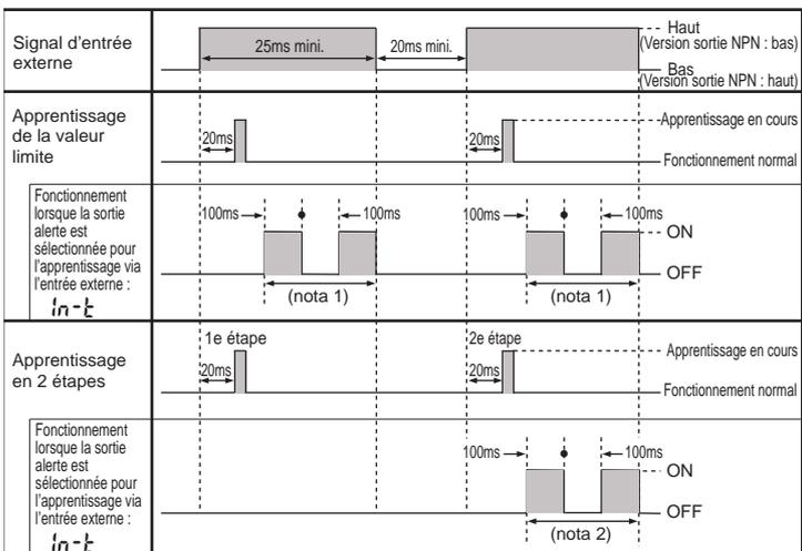
1. Lorsque la marge est insuffisante, la sortie est activée/désactivée toutes les 100ms pendant l'activation du signal d'entrée externe après l'apprentissage.
