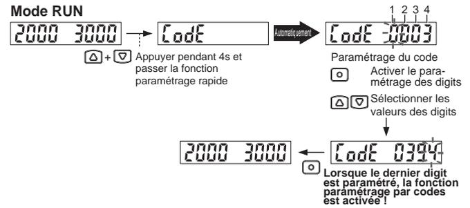
Pendant le paramétrage, appuyez sur <MODE> pendant 2s pour annuler et revenez en mode RUN. Lorsque le dernier digit est paramétré, la fonction paramétrage par codes est activée !
