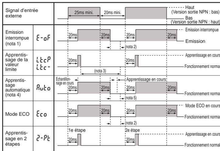
1. En fonction du seuil de commutation, la sortie est activée/désactivée lorsque le capteur émet ou non.
