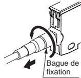
Avant de déconnecter le câble, desserrez entièrement la bague de fixation. Si vous tirez excessivement sur le câble (15N ou plus) lorsque la bague de fixation est serrée, le câble peut rompre.
