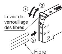
S'il s'agit d'un câble à fibres pour détection directe coaxiale, par ex. FD-G4 ou FD-FM2, le câble à fibres à un conducteur doit être inséré dans l'orifice d'émission du faisceau "P" et le câble à fibres à plusieurs conducteurs dans l'orifice de réception du faisceau "D." S'ils sont insérés inversement, les performances du capteur seront détériorées.
