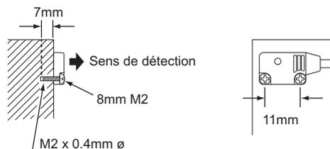
**Montage à l'aide des vis et écrous livrés avec le capteur**
