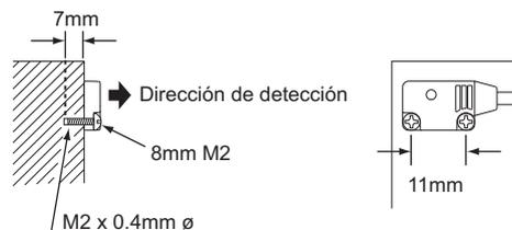
Si se utilizan los tornillos y las tuercas incorporadas
