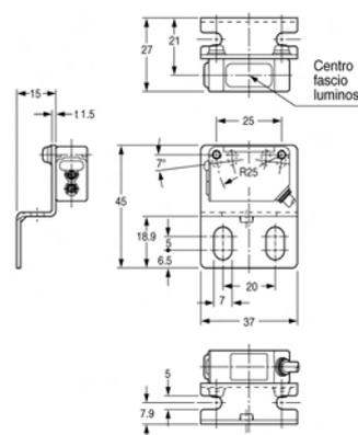
**MS-CX-3** Staffa di montaggio del sensore (in dotazione)
