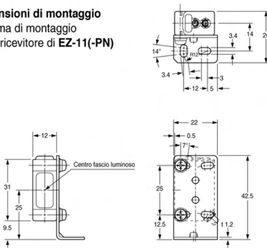
**MS-CX2-2 Staffa di montaggio del sensore (in dotazione)**
