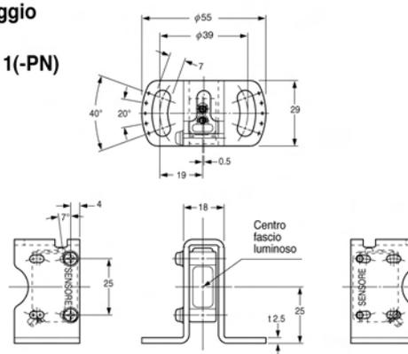
**MS-CX2-5** Staffa di montaggio del sensore (in dotazione)
