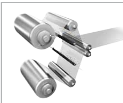
Neutralisation von Folien während des Produktionsprozesses
