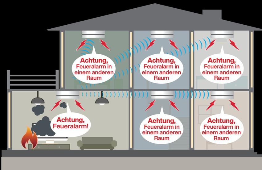
Das Produkt von Panasonic ist so konzipiert, dass im Fall der Auslösung eines Rauchmelders auch alle anderen Rauchmelder mit unterschiedlichen Sprachansagen ausgelöst werden, **um alle Bewohner vor dem Feuer zu warnen**. Installieren Sie einfach in jedem Raum einen Rauchmelder und koppeln Sie alle Geräte mit dem Hauptrauchmelder in einer von neun Sprachen.
